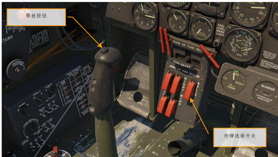
图 102. 释放按钮和炸弹选择开关
