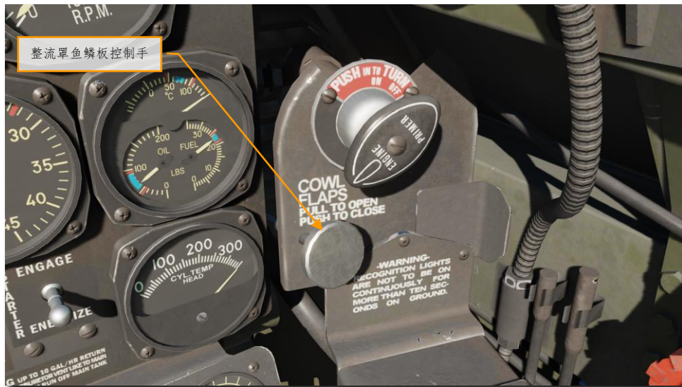
图 67. 整流罩鱼鳞板控制手柄
