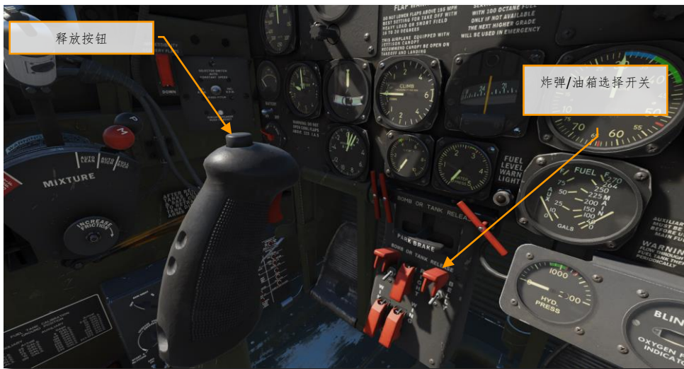
图 93. 炸弹/油箱选择开关
