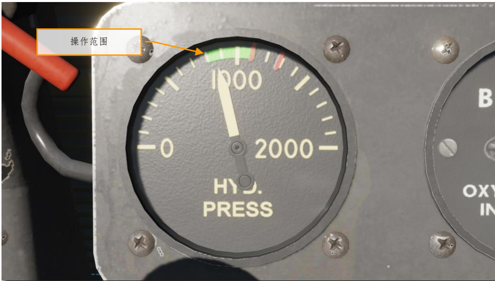
图 92. 操作液压压力范围为 800-1100PSI。最大液压压力——1300PSI
