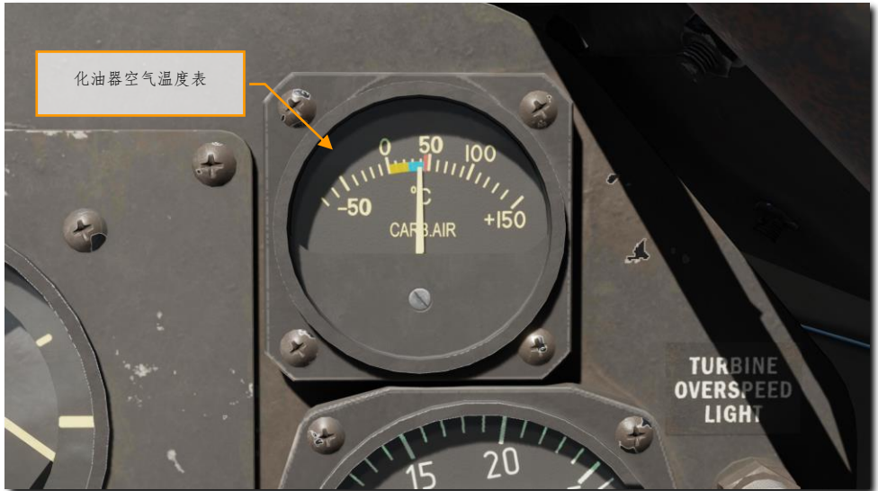
图 53. 化油器空气温度表
